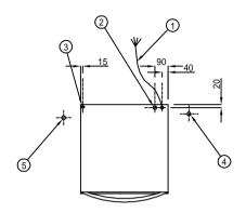
電源コード(機械背面下出側より2m) 配線色 茶、グレー、黒、黄/緑の4芯線接続方法 茶線=赤線(一次側) グレー線=白線(一次側、中性線) 黒線=黒線(一次側) 黄/緑=一次側アース線
